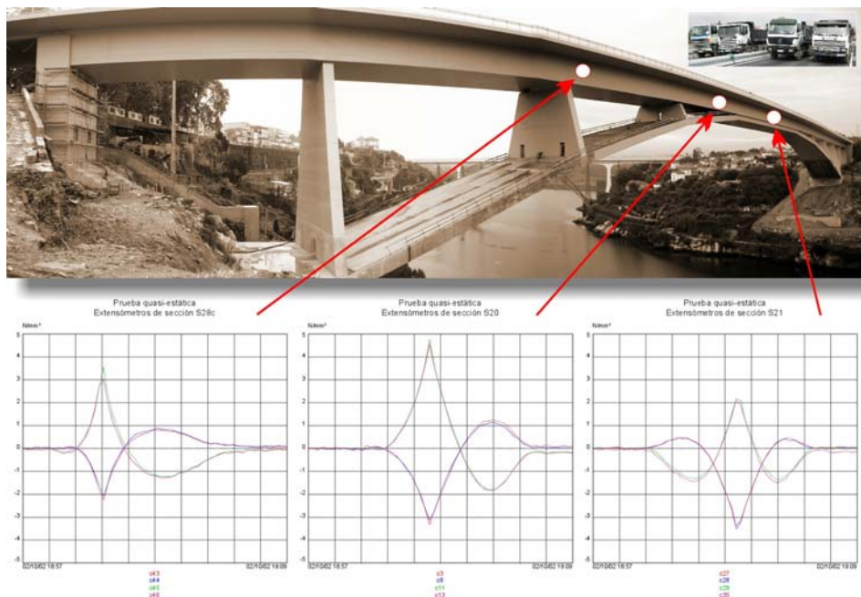
Figura 11 – Linhas de influência das extensões em 3 seções do tabuleiro
