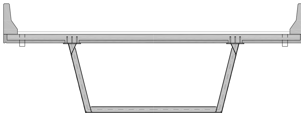
Fig. 7: Secção transversal dos viadutos de acesso
